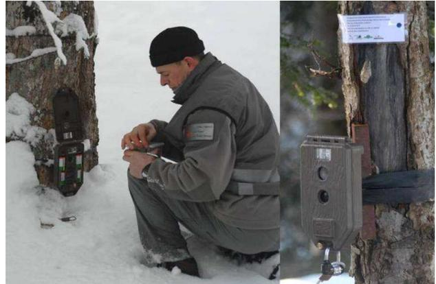
Fig. 2. Mise en place d'un piège photographique.
