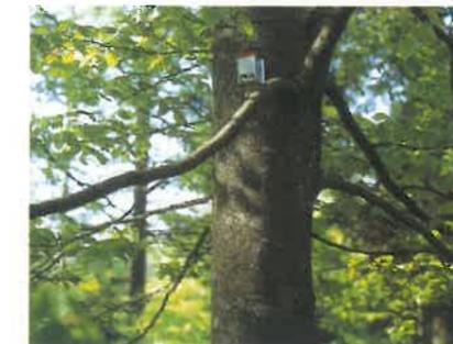
Un émetteur du dispositif d'alarme relié à un piège. L'ours, en tirant sur le câble d'acier, tire en même temps sur un petit fil d'acier qui va faire chuter une canette aimantée à droite de l'émetteur, entraînant l'émission d'un signal radio particulier.
